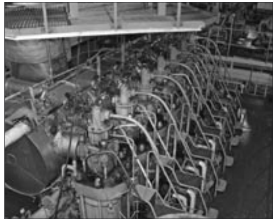
De MAN-B&W motor, type 7S50MC-C is in licentie op de werf gebouwd, 7 cilinders, diameter zuiger: 500 mm en met een slag van 2000 mm produceert de motor een vermogen van 11600 KW (15760 apk). De motor heeft maar één uitlaatgassen turbo, die 18000 omw/min maakt en een ontzettende herrie veroorzaakte. Bij 127 omw/min maakte het schip 18 mijl/uur, maar dan moest het wel redelijk tot mooi weer zijn en dat hadden we meestal wel.
